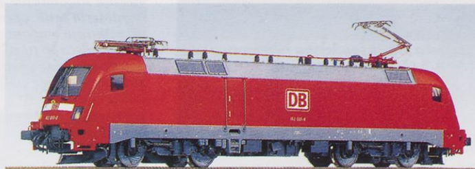
Rocov model najnovejše nemške električne lokomotive serije 1016, poimenovane taurus. Visokosposobna Siemensova lokomotiva zmogla hitrosti do 230 km/h. Prevele so jo tudi železnice Švice, Češke in Madžarske.
