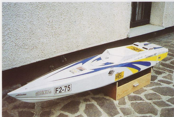
Formula F2-75 je grajena drugače kot večina podobnih modelov. Trup je izdelan iz stiropora.
