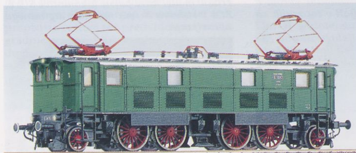
Nasprotje sodobnih električnih lokomotiv je lokomotiva E 16 iz leta 1923, ki je dosegala hitrost 110 km/h (Roco).
