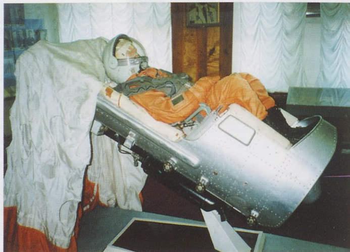
Katalpni sedež, s katerim so se prvi kozmonavti na višini 7000 m izstrelili iz vesoljske ladje Vostok (zgoraj). Maketa nosilne rakete Vostok (levo)
