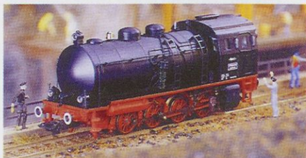
Takšne lokomotive so v zahodni Evropi v šestdesetih letih uporabljali v tovarnah za premikanje vagonov. Lokomotiva je bila brez kurišča in ni zadimljala prostorov. Napajala se je od zunaj, od tod tudi velik kotel za shranjevanje pare (Märklin (digitalna) / Trix).
