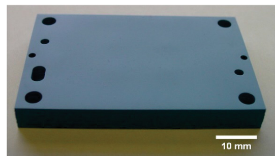
Slika 3: Zaprta LTCC struktura z reakcijsko komoro, kanali in fluidnimi priključki.
