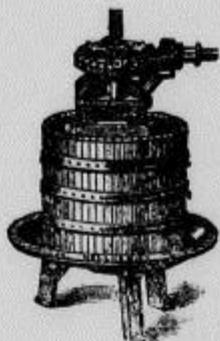
(Diese Pressen haben fast enie solche Druckkraft wie hydraulische Pressen.)
