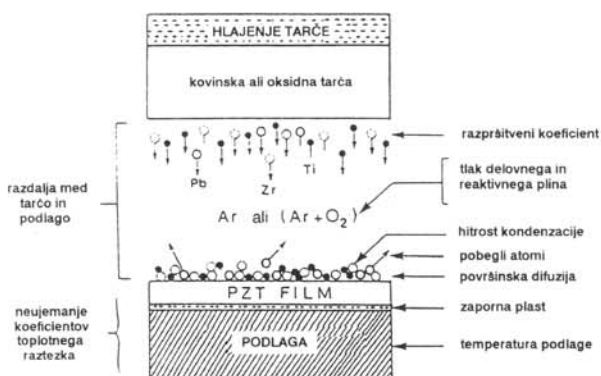
Slika 3: Shema naprševalnika in procesov, ki se v njemu odvijajo
