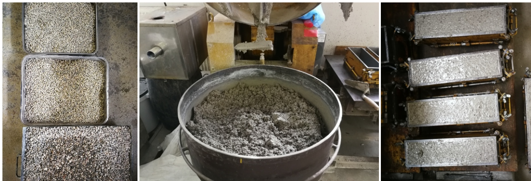
Slika 4.1: Priprava betonskih preizkušancev. Figure 4.1: Preparation of concrete specimens.
