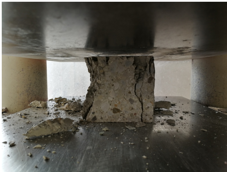
Slika 6.8: Primer porušitve preizkušanca po opravljenem tlačnem testu.
