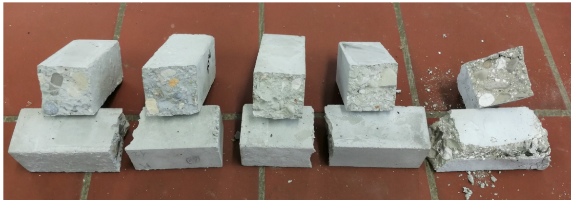
Slika 4.5: Betonske prizme mešanice M5 po izpostavitvi povišanim temperaturam in po opravljenem upogibnem preizkusu, z leve proti desni: 20 °C, 200 °C, 400 °C, 600 °C in 800 °C.
