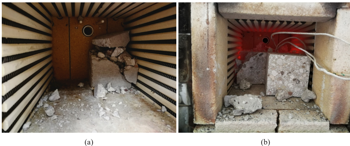
Slika 4.6: Luščenje betonskih preizkušancev: (a) mešanice M2 po izpostavitvi temperaturi 400 °C in (b) mešanice M5 po izpostavitvi temperaturi 600 °C.
