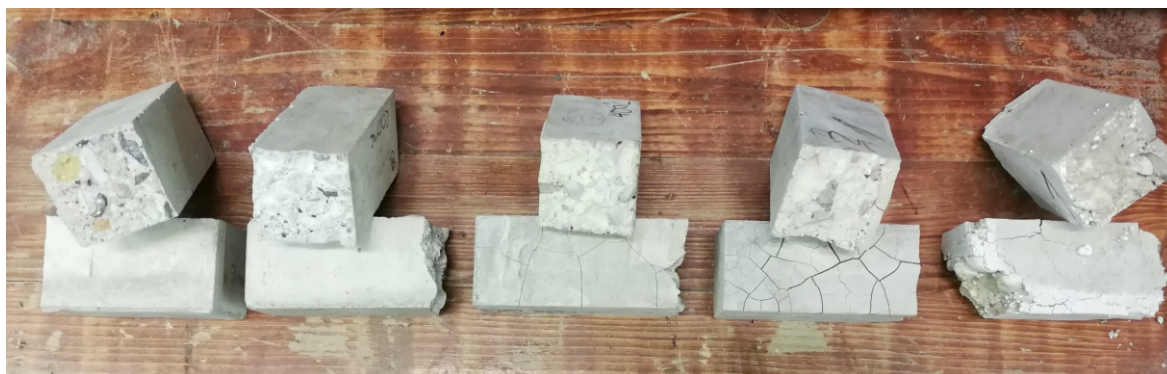
Slika 4.4: Betonske prizme mešanice M1 po izpostavitvi povišanim temperaturam in po opravljenem upogibnem preizkusu, z leve proti desni: 20 °C, 200 °C, 400 °C, 600 °C in 800 °C.
