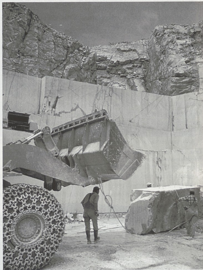
Nalaganje kamnitih blokov za prevoz iz Marmorjevega kamnoloma Lipica II.
