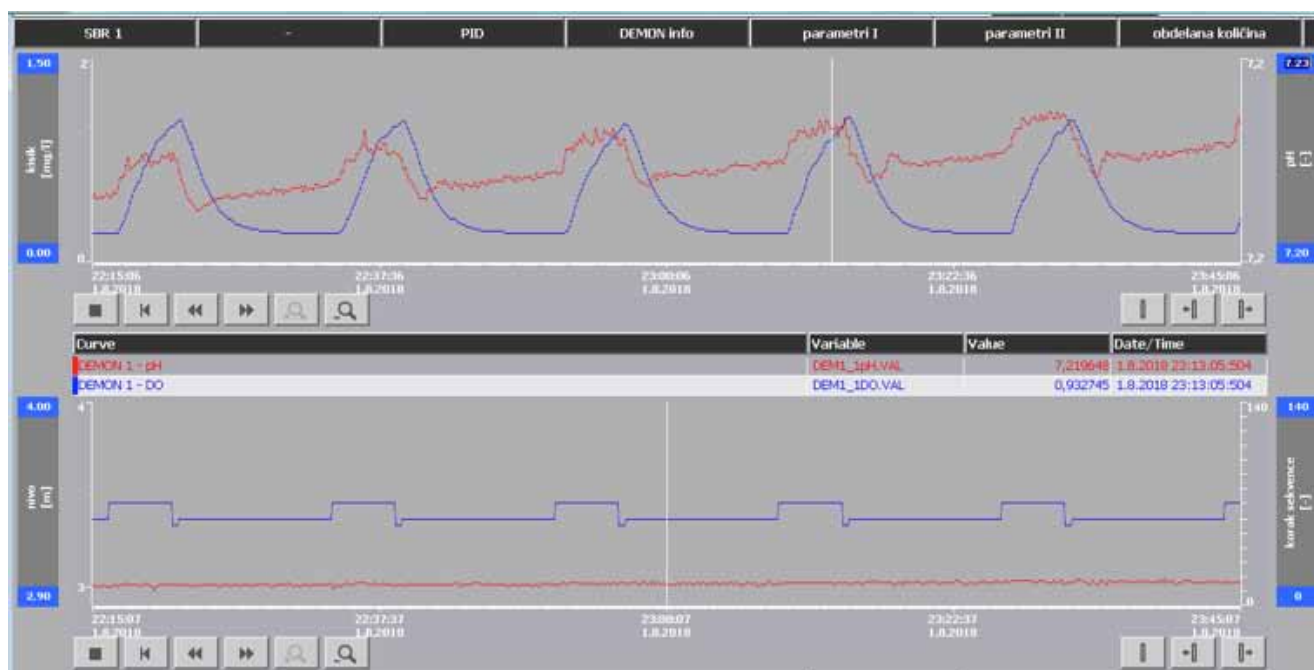
Slika 3: Prikaz stanja postopka po fazah in nivo (spodnji diagram) ter časovni prikaz vrednosti raztopljenega kisika in pH (zgornji diagram)
