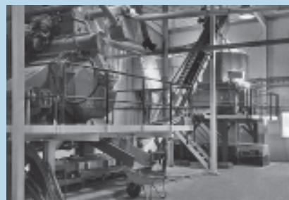
□ Slika 2. Peletirna stiskalnica firme Bühler predeluje na uro 6 ton lesnih ostankov
