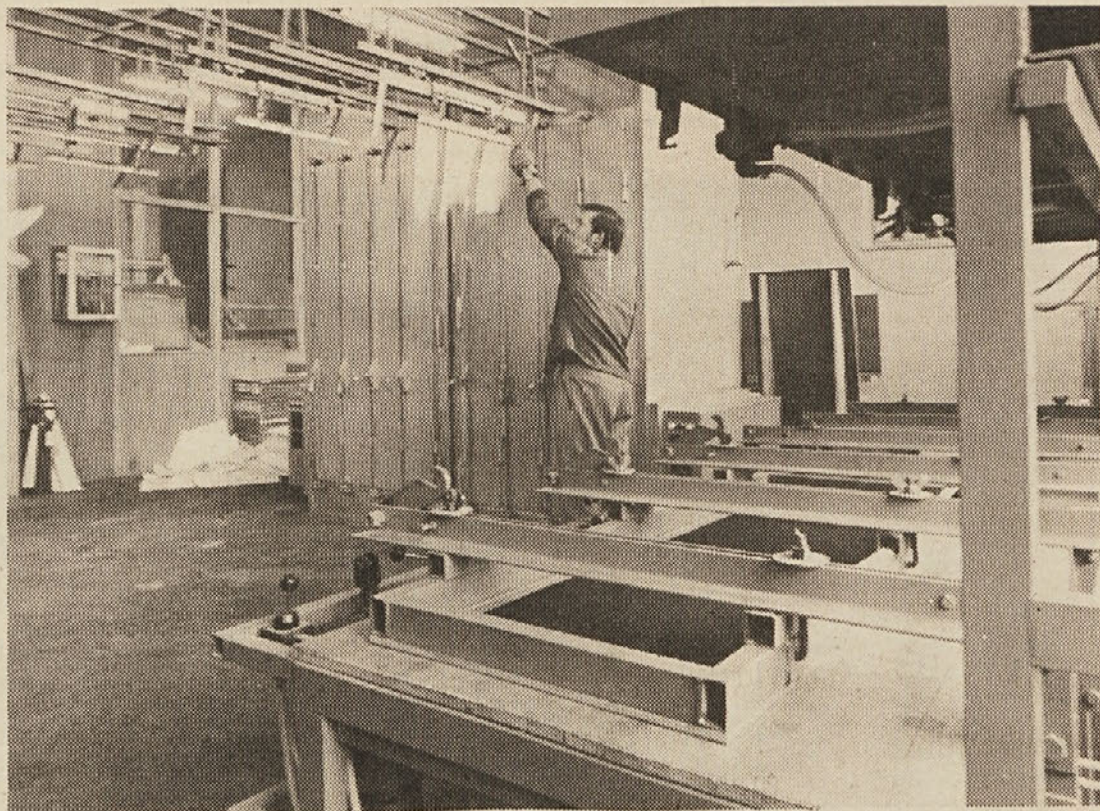
Pleksi steklo obesimo na posebno obešalo in vsak kos posebej porinemo v peč ter segrevamo
