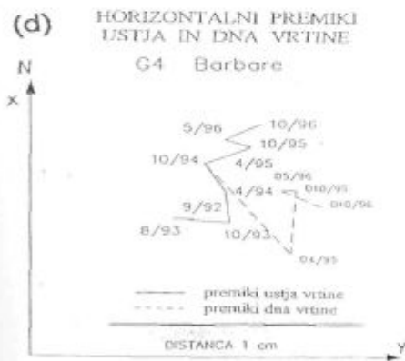
SLIKA 1: PRIKAZ REZULTATOV MERITEV INKLINOMETRSKE VRTINE G4 VRTINA G4 JE BILA IZDELANA NA PLATOJU LESNEGA SKLADIŠČA BARBARE IN JE GLOBOKA 37,5 M. LOKACIJA VRTINE JE OZNAČENA NA SLIKI 4, Z VRTINO SMO PREVRTALI NASIP IN SPODNJE SKITUSKE TER ZGORNJE PERMSKE DOLOMITE (SKICA (a)). V VRTINI SO MONTIRANE POSEBNE CEVI Z UTORI. SMERI UTOROV SO OZNAČENE S +A -A IN +B -B (SKICE (b) IN (e)). MERITVE SE IZVAJAJO DVAKRAT LETNO. MERI SE SMER IN ODKLON V VSAKEM METRU VRTINE. POSEBEN RAČUNALNIŠKI PROGRAM IZMERJENE PODATKE PRERAČUNA IN JIH IZRIŠE KOT DEFORMACIJO VRTINE
