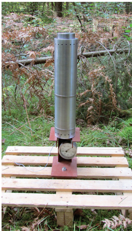
Testni motor je bil šestkrat krajši kot motor končne velikosti.
