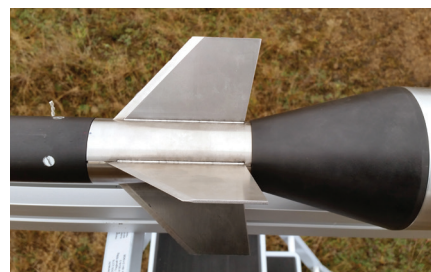
Stabilizatorji druge stopnje so na trup privarjeni z laserjem.
