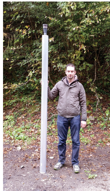
36-kNs raketni motor po uspešnem statičnem testu
