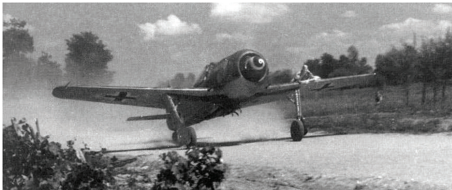
Fw 190F-8 iz sestava SG 4 v Italiji. Lepo se vidi, da nima nosilcev pod krili.
