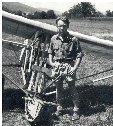
Tečajnik Marko Jeras na Blokah. Lepo se vidi konstrukcija pilotovega sedeža, ki je bila res enostavna. Marko Jeras je bil pozneje član Konstrukcijskega biroja pri IO LZS. (Vir: zbirka Marka Malca)
