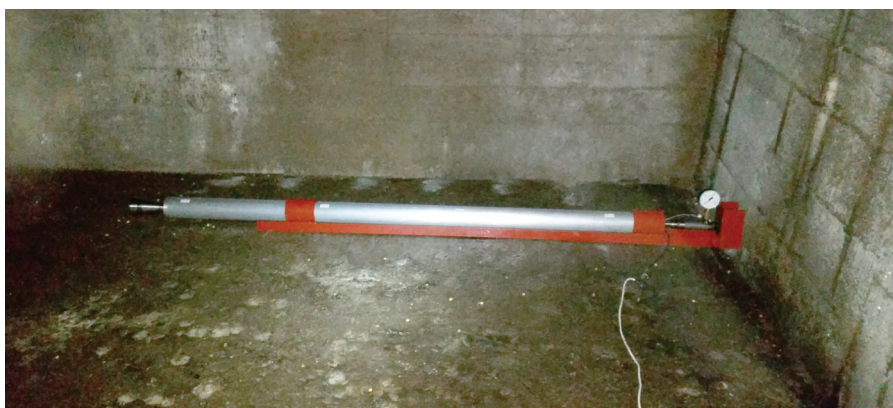
Motor je pripravljen na statični test. Pri tem testu sem izmeril tlak v zgorevalni komori, potisno silo in temperaturo ohišja motorja.
