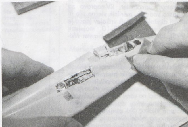
Po vsaki potezi z iglo ali drugim rezilom površino makete obrusimo z vodnobrašilnim papirjem.
