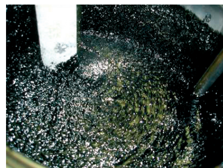
Slika 2 • Vzorec gumibitumna RmB z 18 ut. % gumenega prahu
