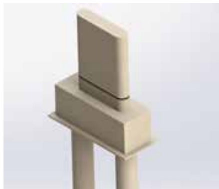
Slika 2 • Aksonometrični prikaz priklučka temeljne AB-grede na AB-pilote.
