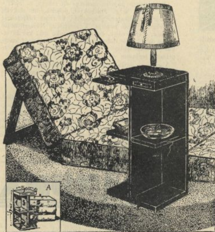
Elegantna miza s policami za knjige, gramofon in druge stvari, ki jih imamo radi hitro pri roki. Vrhnji del ima odlane police, ki se po potrebi potegnejo ven. Spodnja slika nam prikazuje konstrukcijo teh polic.
