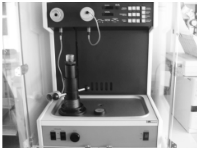
Slika 2: Fotografija živosrebrne porozimetrovske naprave
