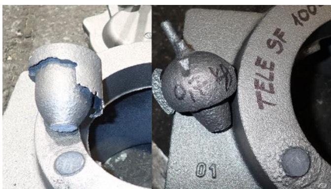
Slika 6. Eksperimentalni rezultati iz Kovis-Livarne: prvotni sistem dovajanja s TELE 195 22 na levi; optimizirani sistem dovajanja s TELE SF 100 18 na desni.
