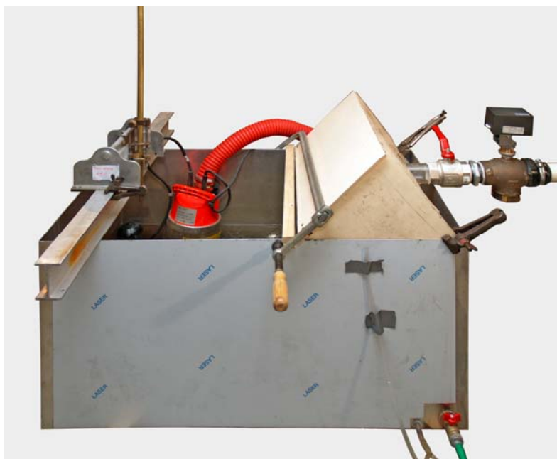
Slika 5.8: Merilna posoda s potopno črpalno
