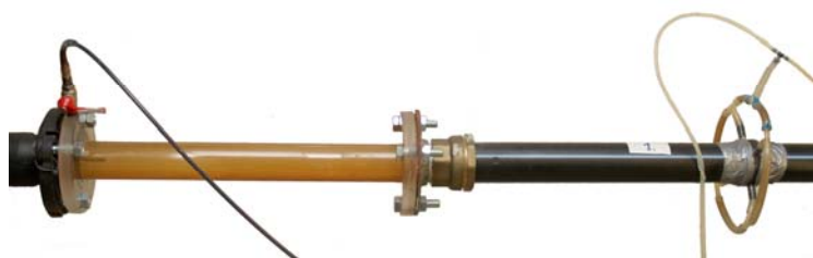
Slika 5.4: Umirjevalni del na vtoku v preizkuševalno cev Figure 5.4: Flow conditioning section at inlet of the pipe
