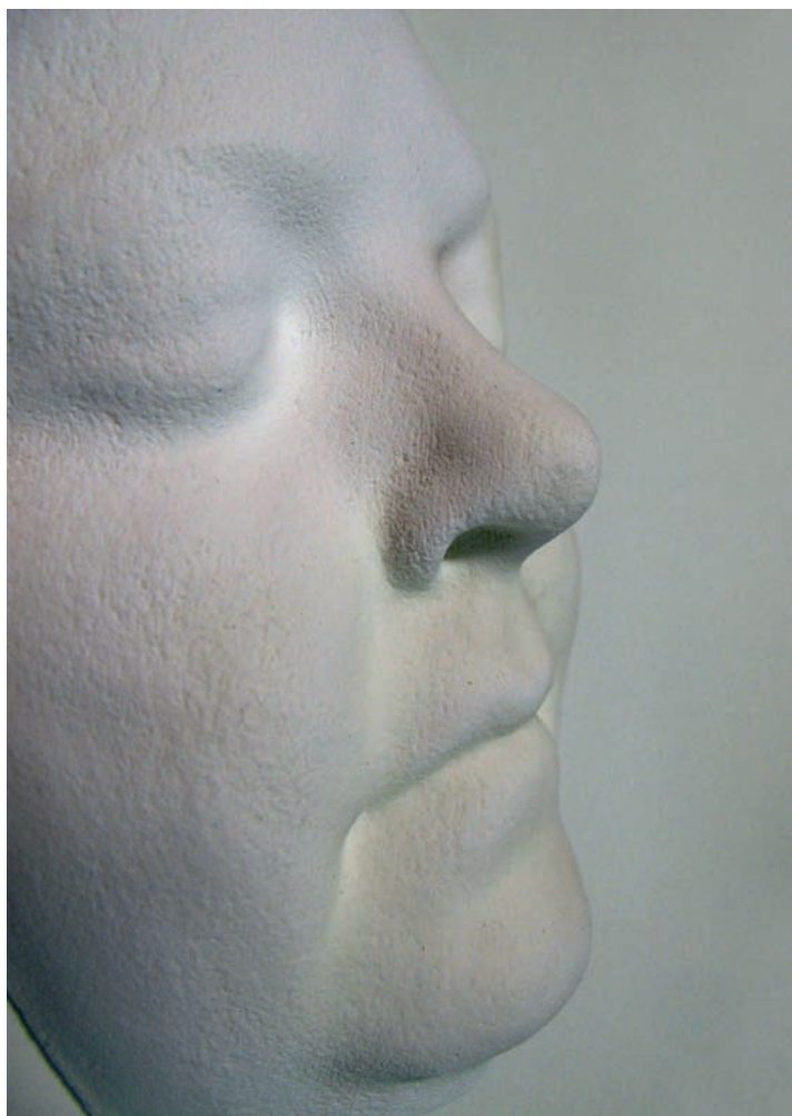
Slika 10. Tridimenzionalno natisnjen obraz, ki smo ga posneli z Z-Scannerjem 800.
