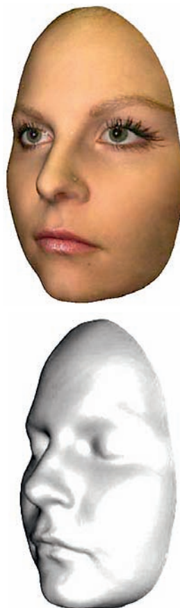
Slika 10. Tridimenzionalno natisnjen obraz, ki smo ga posneli z Z-Scannerjem 800.
