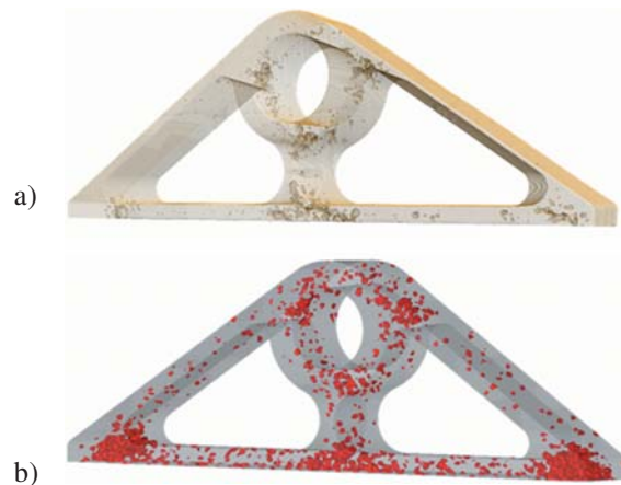
Figure 15: Pore distribution in real component (computertomography) (a), calculated pore distribution (b) Slika 15: Porazdelitev por v realnem elementu (računalniška tomografija) (a), izračunana porazdelitev por (b)
