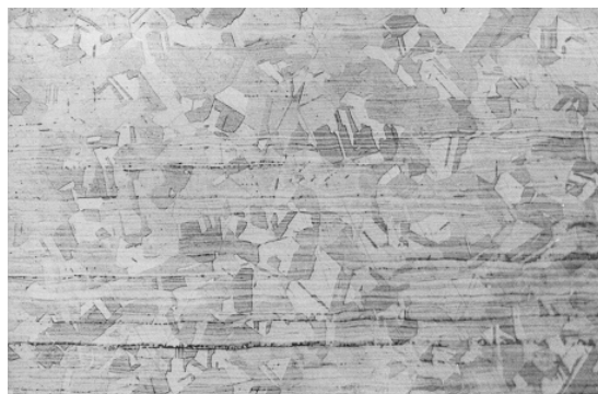
Sl. 3. Mikrostruktura osnovnega materiala cevi
