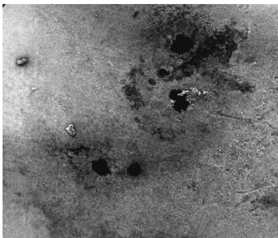
Sl. 8. SEM posnetek gnezda jamic na notranji površini cevi (pov. 10-krat)
