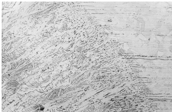
Sl. 5. Prehod iz zvara v osnovni material
