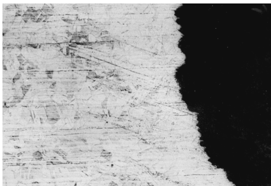
Sl. 6. Mikrostruktura ob korozijski jamici
