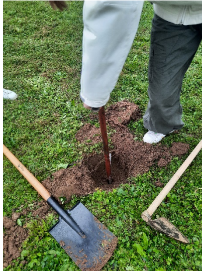
Slika 15: Pridobivanje vzorcev s pomočjo pedološkega svedra, S. Stružnik
