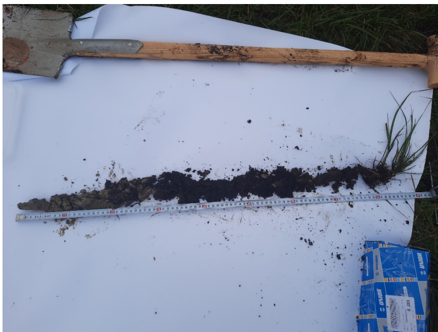
Slika 17: Pridobljen profil prsti s pomočjo pedološkega svedra, S. Stružnik
