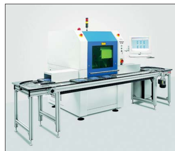
Slika 8. LPKF MarkLine – laserski markirni sistem s tekočim trakom
