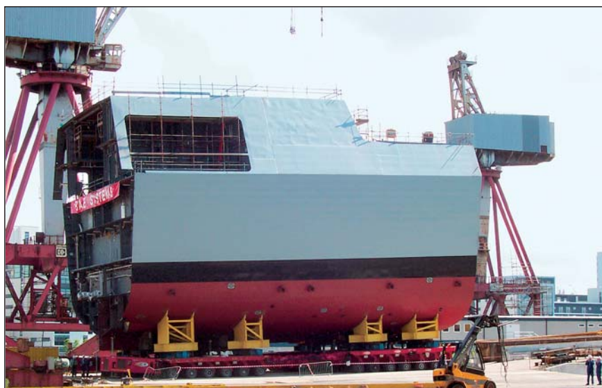
Slika 2. Vsaka sekcija ladje se na navoz transportira z večkolesno premično ploščadjo
