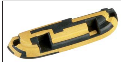
Slika 6. Antena mobilnega telefona, izdelana v tehnologiji 3D-MID
