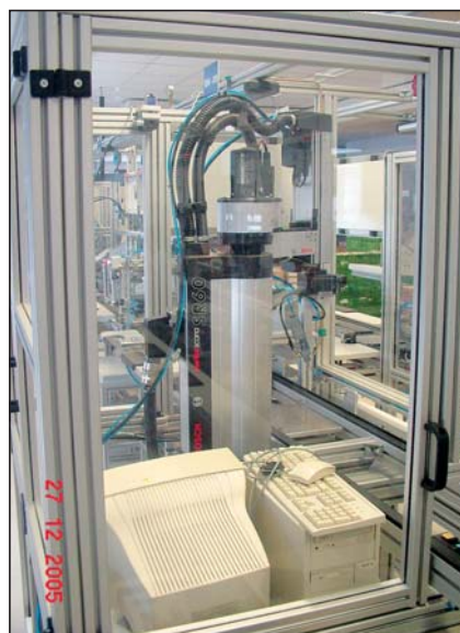
Slika 3. Avtomatizacija mazanja z robotom Bosch
