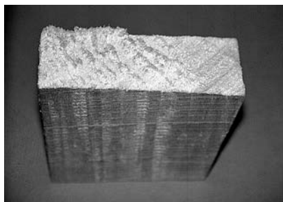
Slika 1. Topol ( Populus spp.): značilna volnatost zaradi velikega dela tenzijskega lesa
