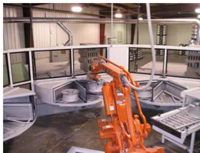
Slika 1.3: Prvi nivo varovanja s f zično ograjo in rotirajočo mizo
