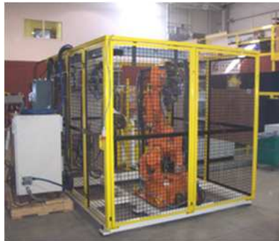
Slika 1.2: Prvi nivo varovanja s f zično ograjo in vrati
