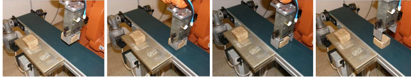
Prenos kocke nad tekoči trak (pred optični senzor)
