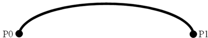
Slika 6.16: Premikanje vrha robota, ko je uporabljen ukaz Go
