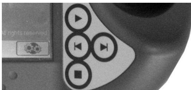
Slika 5.23: Tipke na ročni učni enoti za preverjanje gibanja robota po programu
