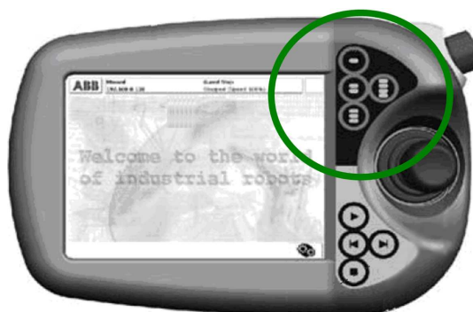
Slika 5.6. Tipke na ročni učni enoti za zagon oz. zaustavljanje tekočega traku in manipulacijo prijemala
