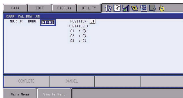
Slika 4.12: Okno za medsebojno kalibracijo robotov
