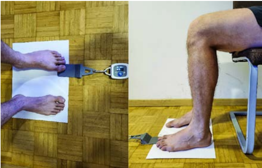
Slika 1: Prikaz postavitve dinamometra in preiskovanca
