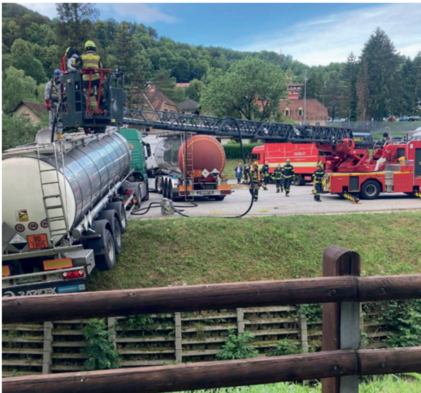
Slika 2: Prečrpavanje fosforjeve kisline v drugo cisterno
