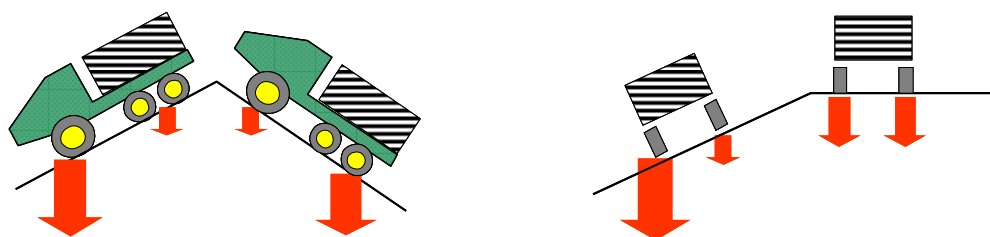
Slika 19: Povečanje tlaka stroja na tla zaradi spremembe naklona terena (Košir B., 2010a)
