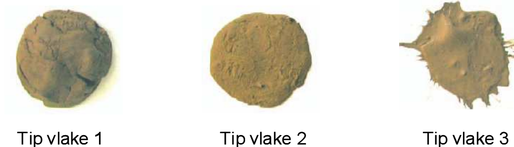
Slika 21: Praktični test vlažnosti tal - metanje kepe tal ob čvrsto podlago (Kremer J. in sod., 2007)
