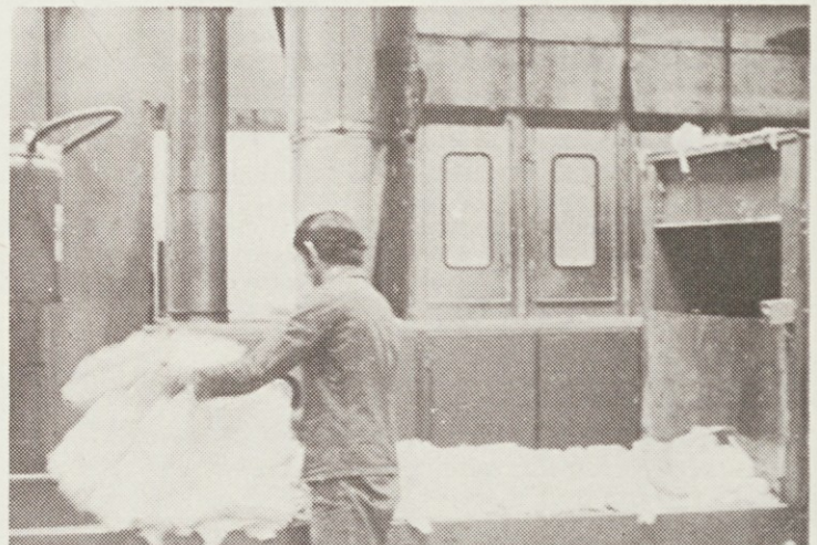
Plasti bombažnih vlaken nalaga posluževalec enakomerno po dolžini letvastega traku rahljalnega stroja
