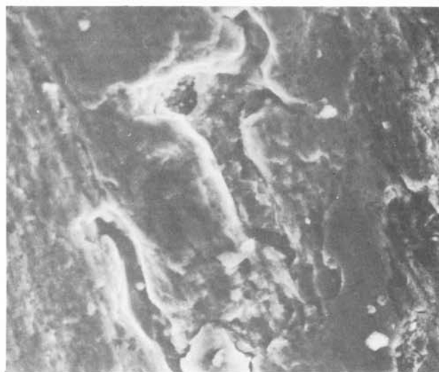
Sl. 11. Mikrorelief rezilnega robu obrezilne matrice brez nanosa TiN
