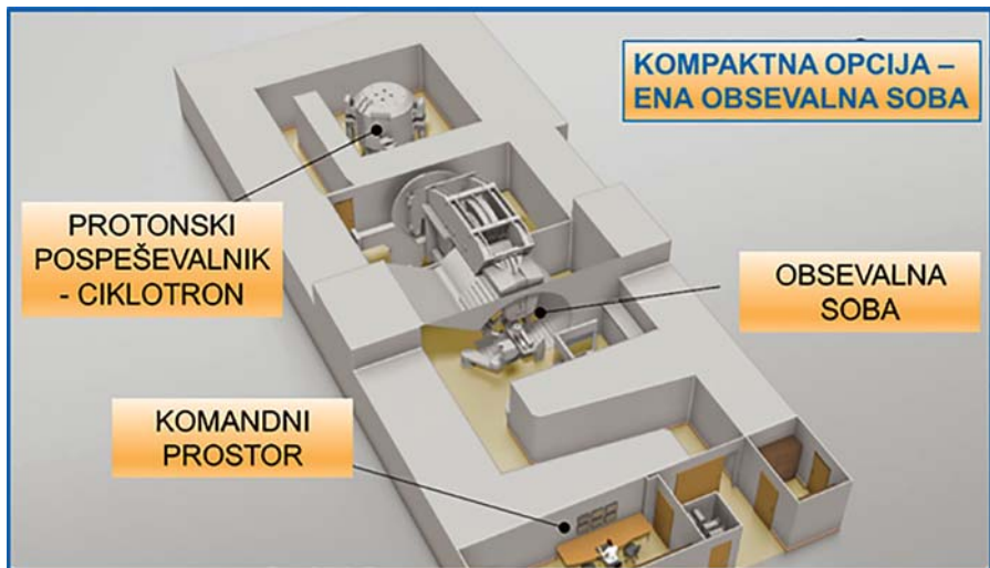
Slika 4. Shematski prikaz protonskega pospeševalnika in obsevalne sobe v kompaktni izvedbi z eno obsevalno sobo
