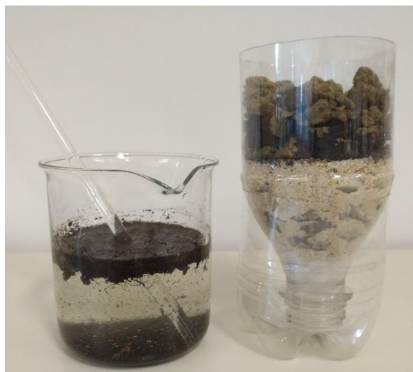
Slika 2: »Čistilna naprava« s prikazano razporeditvijo filtrov.
