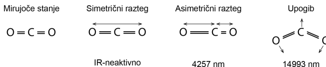
Slika 2: Molekula CO_2 v različnih vibracijskih stanjih. V mirujočem stanju molekula nima električnega dipola, podobno je tudi v primeru simetričnega raztegovanja. Za absorpcijo IR-valovanja sta pomembna asimetrično raztegovanje in upogibanje molekule z značilnima frekvencama oz. valovnima dolžinama [17].
