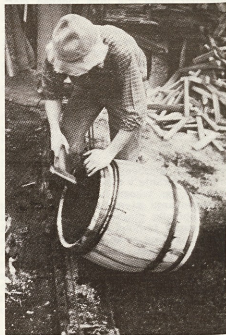
Doge so ukrivljene. Zdaj je treba nabiti spodnji obroč in sneti jekleno zanko.
