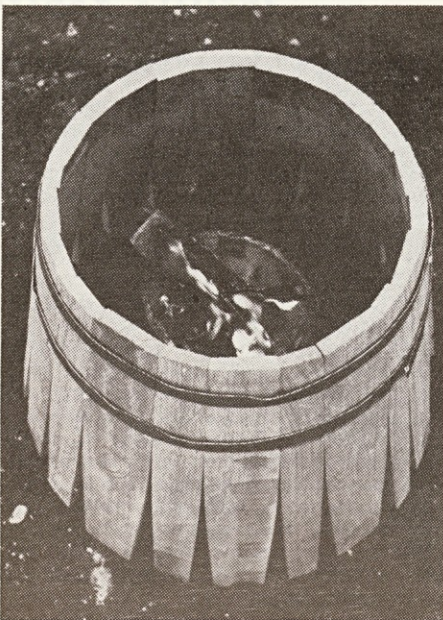
Doge so ukrivljene. Zdaj je treba nabiti spodnji obroč in sneti jekleno zanko.
