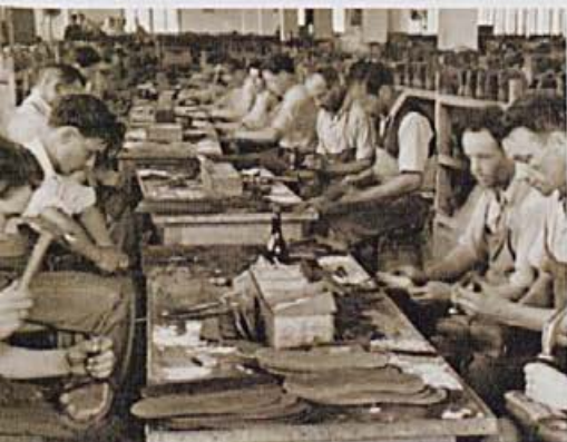
Obutev so izdelovali ročno. Leta 1955 so se odločili za strojni način dela. Slika iz leta 1954 prikazuje pribijanje podplatov na zgornji del obutve. Podplate so pribijali s cvetki (lesenimi žeblički).
