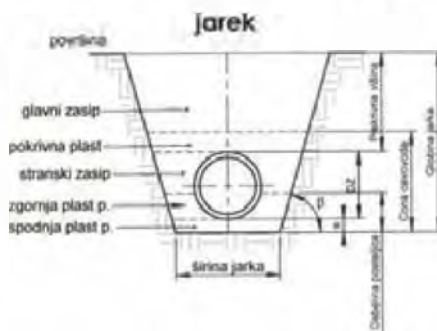
Slika 2: Vgradnja kanalizacijske cevi
