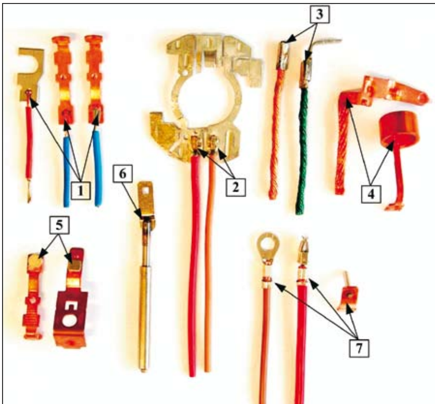
Slika 1. Prikaz nekaterih električnih elementov, ki so spojeni z različnimi postopki: 1 – lasersko varjeni spoji, 2 – elektroporovno zvarjeni žici z drugim elementom, 3 – elementi, spojeni s hibridnim postopkom (kompaktiranje), 4 – ultrazvočno zvarjena elementa, 5 – ploščici, ki sta spajkani z električno upornovno energijo, 6 – spoj, izdelan z elektroporovnim varjenjem, 7 – zvarjeni spoji, izdelani z mehansko energijo
