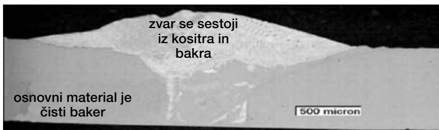
Slika 7. Makroobrus lasersko izdelanega spoja iz pokositrenih bakrenih žic s čistim bakrom
