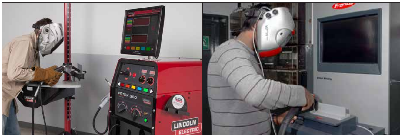
Dve virtualni napravi, ki delujeta na različnih fizikalnih principih za učenje ročne varjenja MAG/MIG
