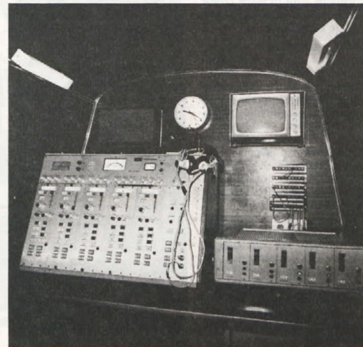
Elektronika v klimatizirani in zvočno izolirani notranjosti vozila, iz katerega usmerjajo sliko in ton iz petih komentatorskih mest.
