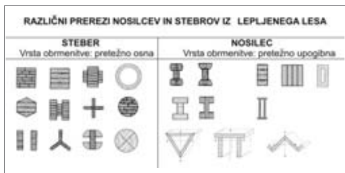
Slika 6: Različni prečni prerezi stebrov in nosilcev iz lepljenega lesa. Glued members are available in a wide range of sections sizes to suit every application. Pro:Holz Austria, 2002, str. 84.
