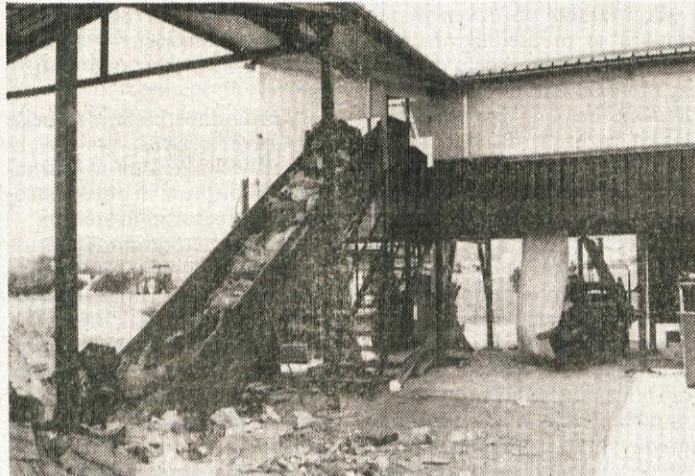
Vse trde odpadke odpeljejo v zbiralnico, kjer je treba ročno ločiti papir, plastiko, stiropor, manjše kovinske dele, steklo, pločevinke,... Ves papir stisnejo v bale in ga skladiščijo za prodajo v nadaljnjo predelavo. Tudi plastiko stiskajo v bale in jih pripravijo za izvoz v Italijo. Trdo plastiko pa zmeljejo in njihov kooperant izdeluje kompostnike. Stiropor pa oddajo za izdelavo izolacijskih materialov.
