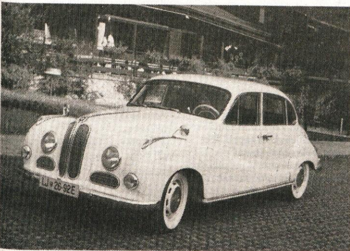
Stari lepotec BMW V8, lastnik Angelo Penko, letnik 1957, 2600 cm 3 , 100 KM, v tisti dobi je bila najhitrejša serijsko izdelana limuzina v Evropi s 165 km/h.
