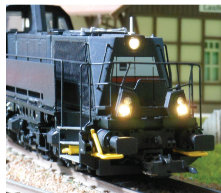
V sprednje značilne poševne žaromete, ki so skladni s pročeljem havbe, so vgrajene tri tople bele svetleče diode v žarometih.
