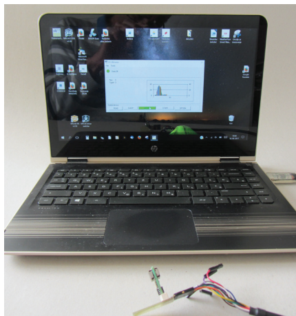
S PC-jem omogočimo zajem vseh podatkov modelarskega višinomera, obdelavo in prikaz profila leta modelarske rakete.
