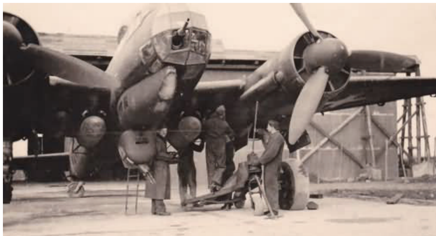
Ju 88A-4 z zakritimi izpuhi za nočno letenje in gibljivim 20-mm topom MG FF v nosu
