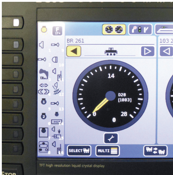
ESU-jeva digitalna centrala ECoS 50200 zasnova ESU-jev model lokomotive BR 261 in avtomatsko izpiše vse funkcije, shranjene v dekodirniku LokSound V4.0 M4.
