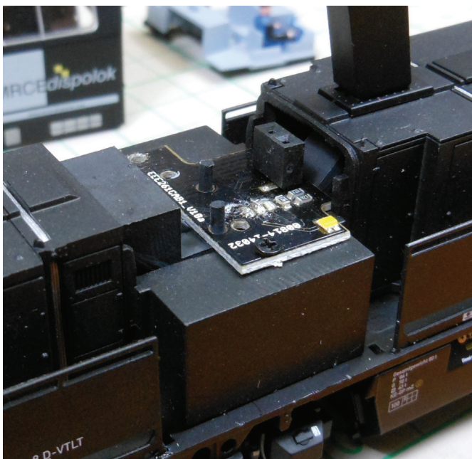
Pod komandnim pultom je tiskano vezje z dvema svetlečima diodama za osvetlitev armaturne plošče.
