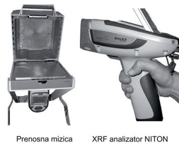
Slika 2. Prenosni XRF analizator NITON GOLDD XL3t+ (foto: M. Udovič, NTF).
