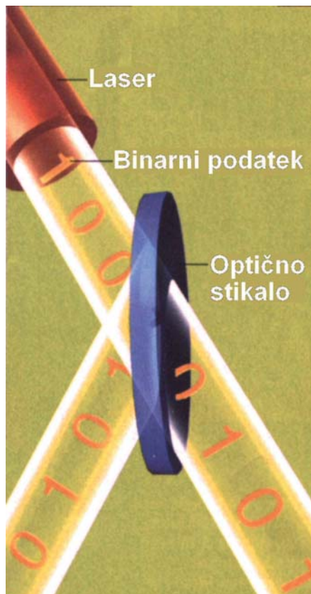
Ogromno povečanje hitrosti računalnikov: optična stikala bodo igrala vlogo različnih logičnih vrat.
