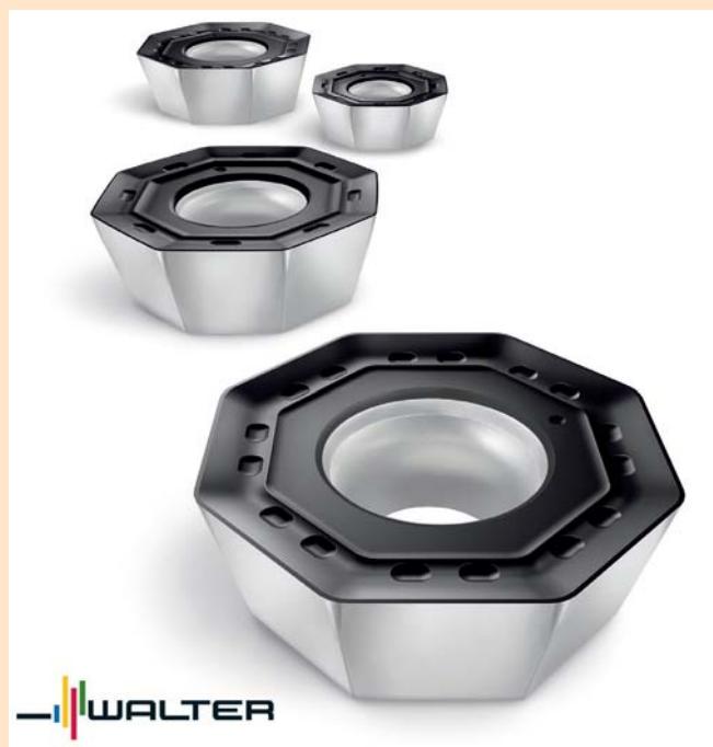
Novi vrhunski material Tiger-tec® Silver za rezalna orodja je ime dobil po svoji sijoči srebrni rezalni strani. Cepilna stran je črna kot pri prejšnji generaciji. Walter je ohranil dvotonski zaključek, ki je potrjena podlaga za odkrivanje obrabe. (Slika: Walter AG)
