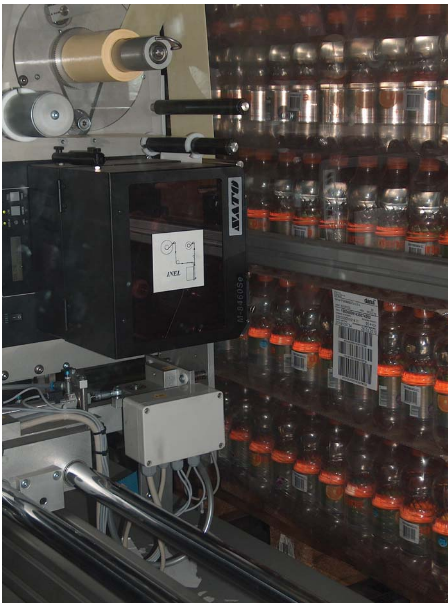
Slika 2: Naprava za označevanje logističnih enot, vgrajena v logistični sistem
