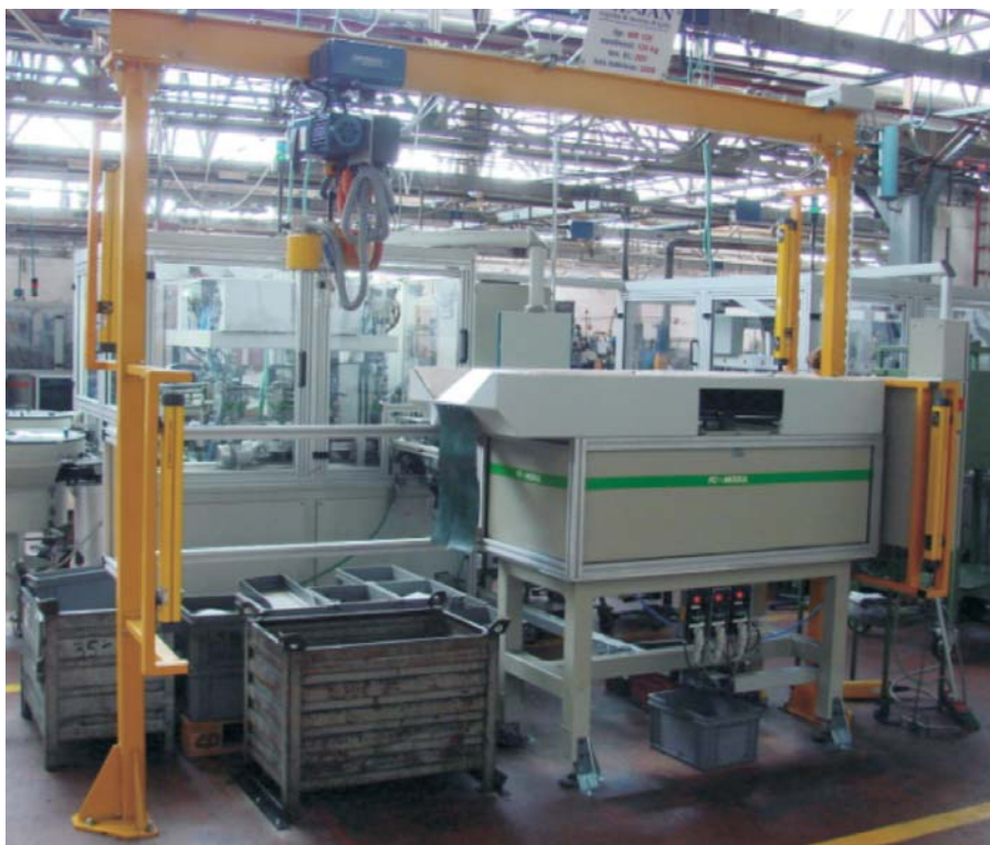
Slika 2: Vstavljanje NT-letvice z avtomatiziranim dvigalom z magnetom
