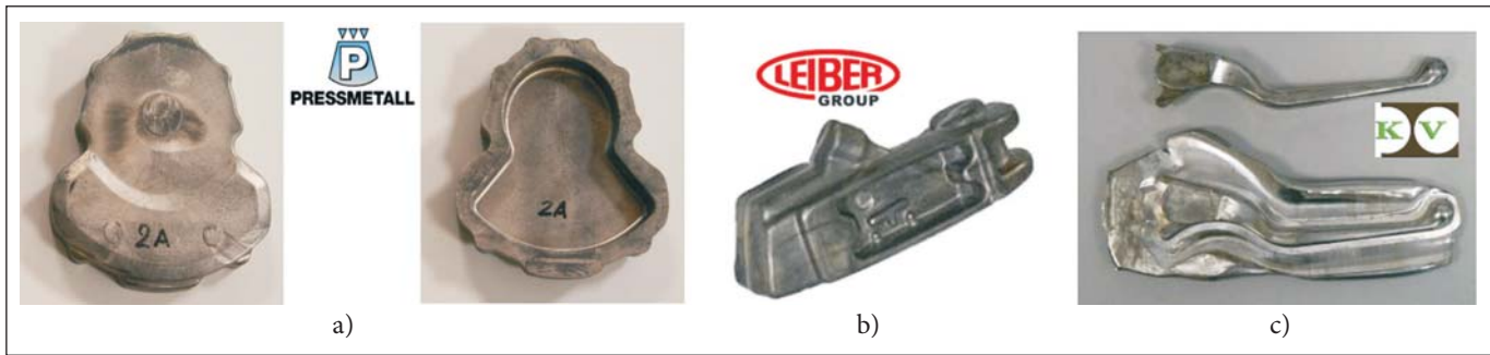
Slika 4: a) Ohišje dušilca krmilnega mehanizma za motocikel, kovanega iz AZ80 v podjetju Pressmetall (Švedska); b) kos za zavorni mehanizem kolesa, kovan iz AZ80 v podjetju Leiber (Nemčija); in c) zavorna ročka za motocikel, kovana iz ZK60 v podjetju Kovinar (Vitanje) [9]
