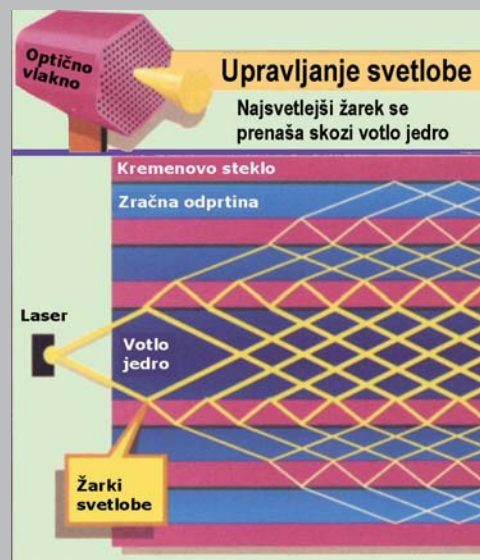
Kako povečati moč in zmanjšati izgube: struktura optičnega vlakna z votlino v sredini
