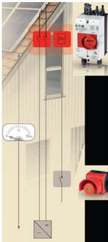
Slika 3: Primer vgradnje DC-očilnega stikala za dvopolno prekinitev povezave PV-generatorja s pretvornikom. Stikalo se vgradi v povezavo v neposredni bližini PV-modulov. Stikalo lahko izklopimo tudi z izklopom krmilne napetosti – s posebnim stikalom STOP, ki ga namestimo na lahko dostopnem mestu. (Vir: EATON)
