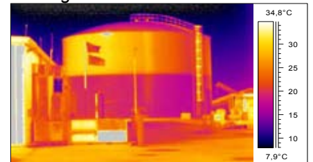
Termogram rezervoarja s tekočino
