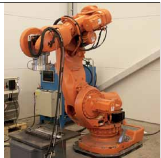
Varjenje z gnetenjem: levo – princip varjenja, desno – robot, ki takšno varjenje izvaja
