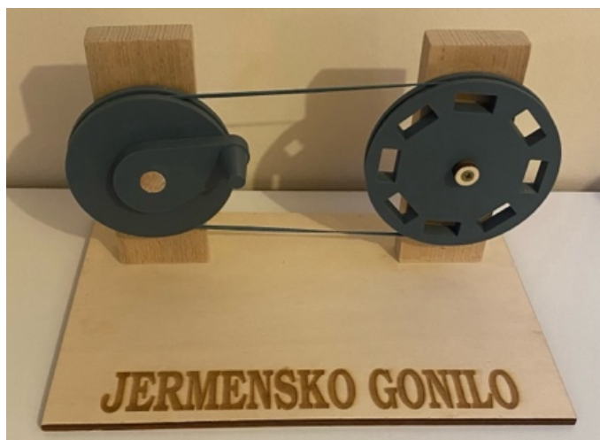
Slika 1: Končni izdelek – model jermenskega gonila.
