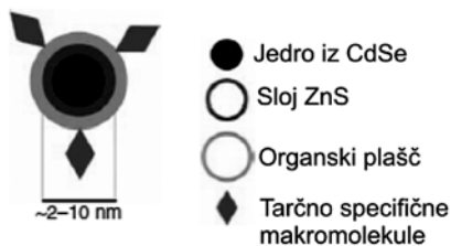
Slika 6: Zgradba kvantne pike. Kvantne pike za uporabo v fluorescenčni mikroskopiji so najpogosteje sestavljene iz jedra iz CdSe, ki fluorescira, sloja ZnS, ki prepreči prehajanje kadmija in selena v okoliški medij in izboljša optične lastnosti kvantne pike, ter organskega plašča, ki je potreben za topnost kvantnih pik v vodi in vezavo tarčno specifičnih makromolekul (Prirejeno z dovoljenjem Macmillan Publishers Ltd: Nature Methods (Giepmans in sod. 2005)).
