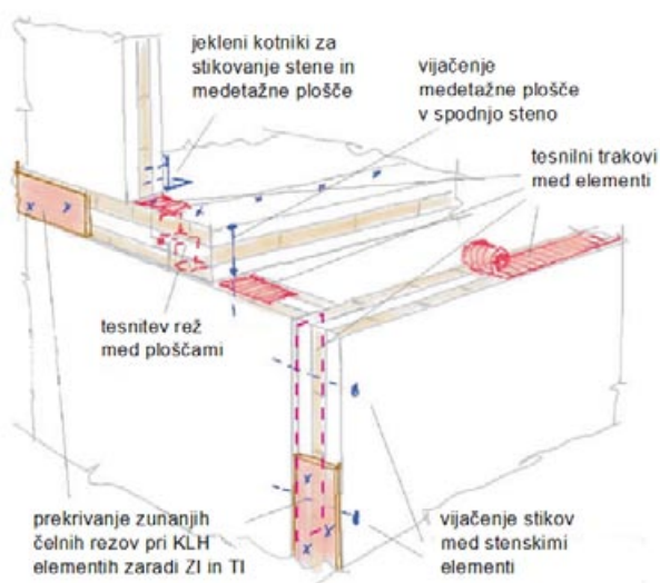
■ Slika 5. Detajl stikovanja v medetaži (KLH Massivholz, 2001).
