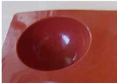
[Slika 6] Silikonski model za strjenko polkrogle oblike
