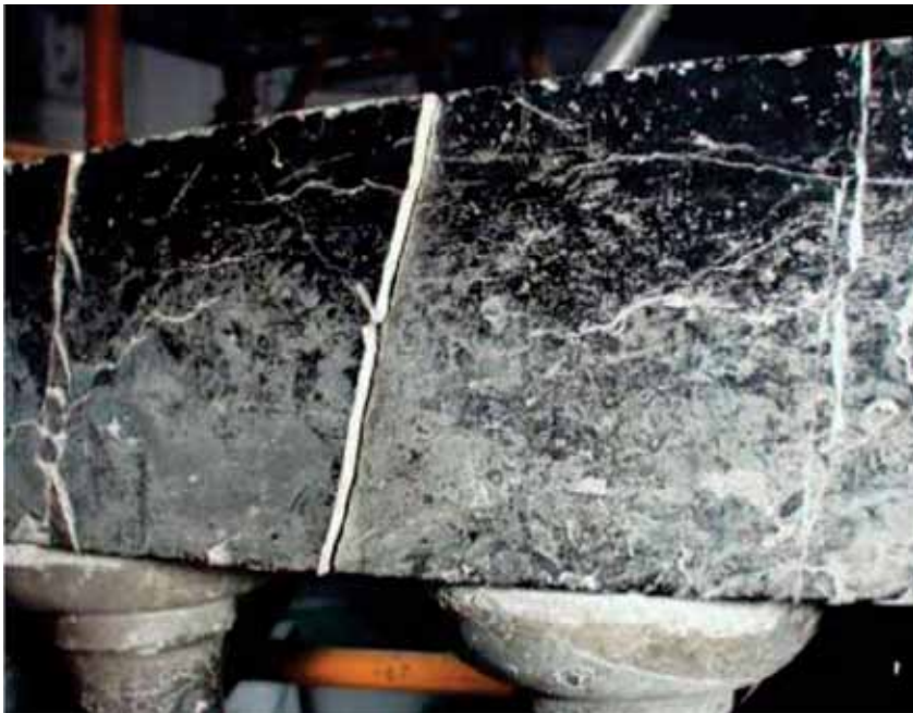
Slika 6. Oblike propadanja apnenca Drenov Grič iz skupine Razpoke in deformacije: a) razpoke, neodvisne od teksture kamnine (dolžina slike 100 cm)
